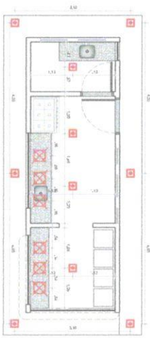
04 PLANTA DE ILUMINAÇÃO
